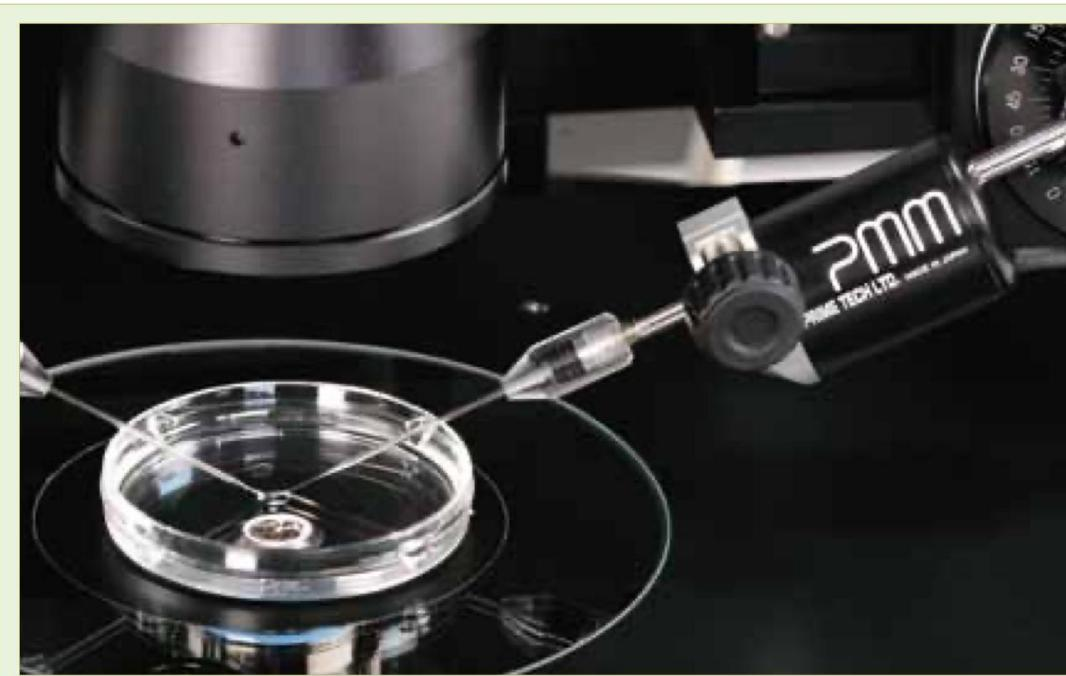
高度にコントロールしたピエゾ素子の伸縮力をピエゾインパクトフォースとして試料への優れた穿刺性を発揮。自社での発生工学研究で使用、改良を重ね、安定的な穿刺性と使い易さに磨きをかけたピエゾマイクロマニピュレータ "PMM4G"。ピエゾインジェクションのパイオニアである当社が豊富なノウハウを注ぎ込んだ4代目Piezo MicroManipulatorです。
